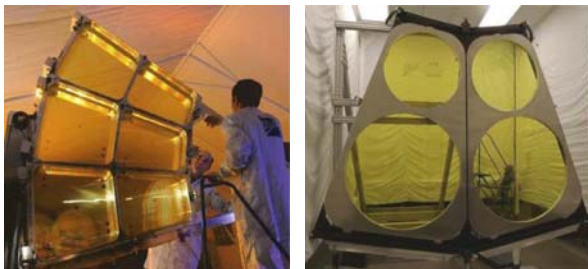
(a)5 m主镜的1/8部分 (b)10 m验证样机主镜的1/9部分 (a)1/8 of 5-m-diam PM (b)1/9 of 10-m-diam PM
