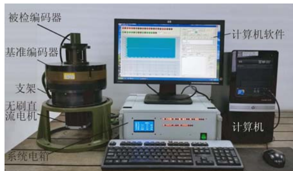
图 1 光电编码器动态误差检测转台
