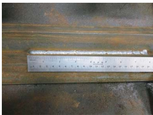
图 15 采用自适应模糊控制得到的焊接结果
