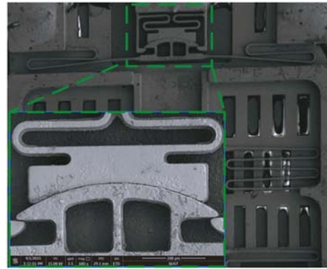
图 13 微开关闭锁状态 SEM 图像
