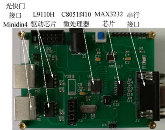
图 7 光快门驱动与控制电路
