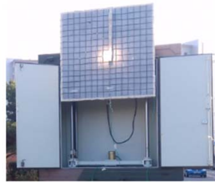
图 10 指向精度实验使用的靶板
