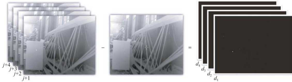
图 1 由序列图像生成差分检测图像的过程
