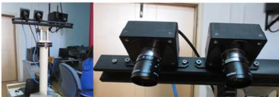
图 2 双目视觉相机及实验平台
