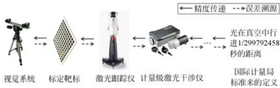
图 3 高精度视觉系统的误差溯源链
