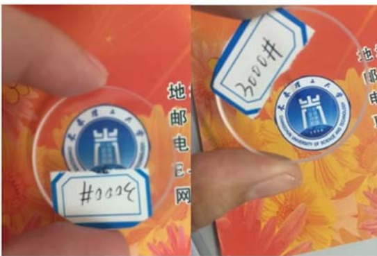
图 6 镁铝尖晶石磨削前和磨削后的透光率对比
