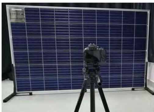
图 4 粘贴分辨率测试板的光伏组件
