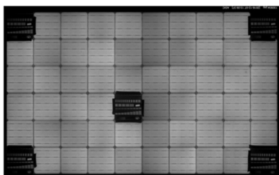
图 5 带有分辨率测试板的组件的 EL 图像
