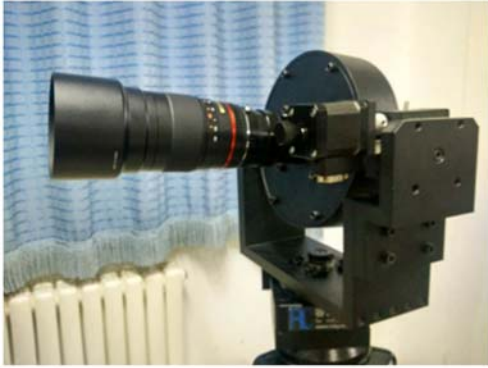
图 5 星光折射传感器原理样机实物图
