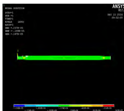
图 6 镀钯金膜光纤 EFPI 传感器的应变
