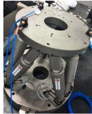
图 5 Stewart 平台模态测试示意图
