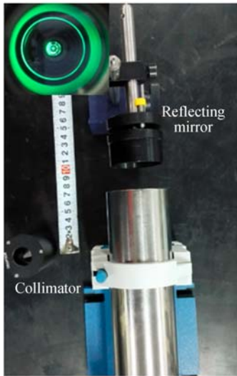
图 2 波前斜率测量示意图
