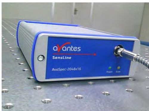
图 5 AvaSpec-2048 光纤光谱仪
