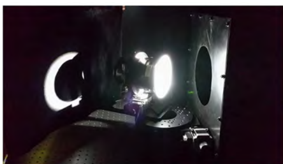
图 8 遮光罩出口辐照度分布实验测量图
