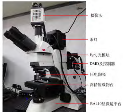
图 6 基于 DMD 的共聚焦显微测量系统
