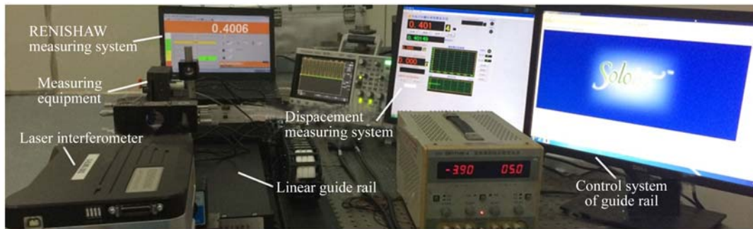
图 12 交变光场时空耦合型位移测量系统实验平台
