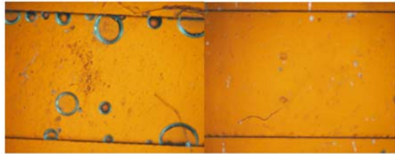
图 6 芯片入口(排气前)和出口(排气后)处沟道中的气泡情况
