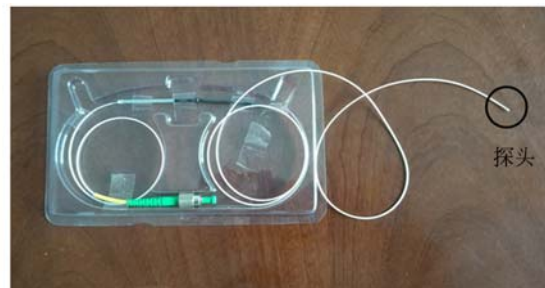
(b) 包裹聚氨酯套管的探头及光纤
