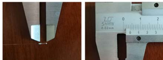
(a) 玻璃管封装的光纤光栅探头
