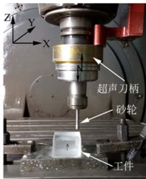
图 5 超声辅助套料试验装置
