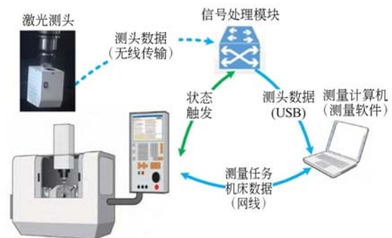
图 2 激光在机测量系统工作原理图
