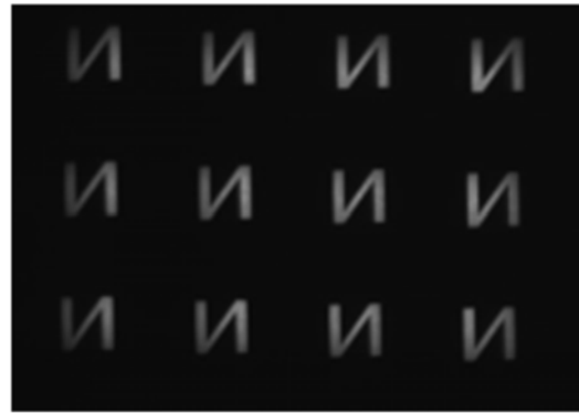
图 7 微透镜阵列膜对字母“N”成像
