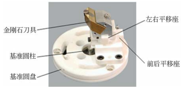
图 10 刀具装夹结构
