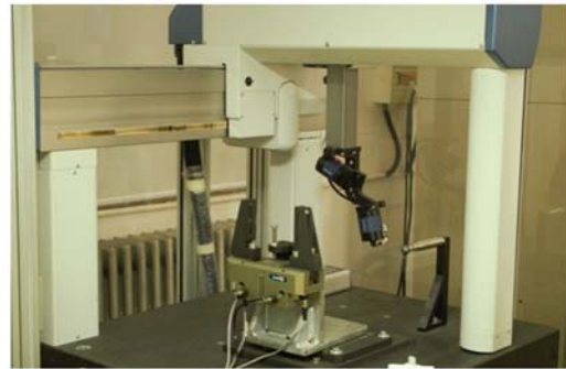
图 2 叶片进排气边光学测量系统
