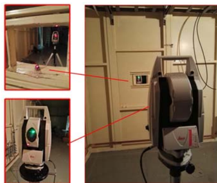
图 9 上海光源现场双面互瞄定向实验
