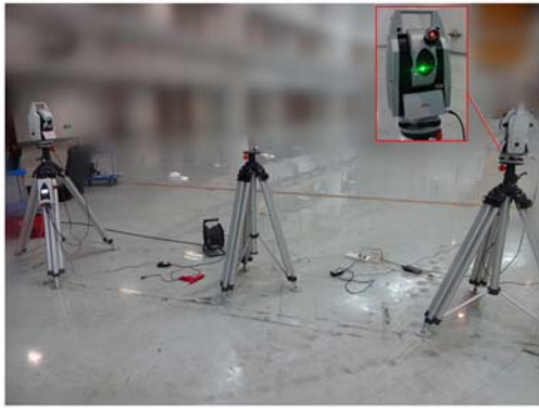
图 5 双面互瞄法定向实验
