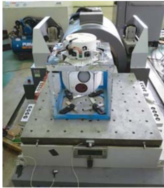
图 9 模拟飞机线振动的振动台
