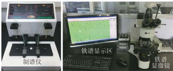
图 2 铁谱磨粒图像采集系统
