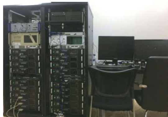
图 4 波前处理器以及高压放大器电子学系统的实物照片 Fig. 4 Physical photos of wavefront processor and high voltage amplifier electronics system
