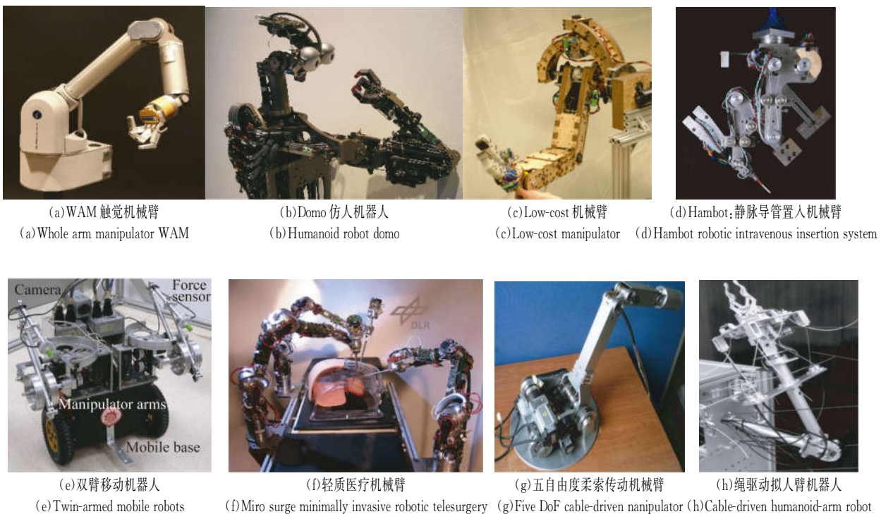
图 2 柔索传动技术在人机交互机械臂中的应用
