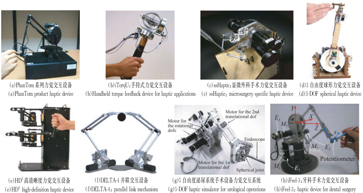
图 3 柔索传动技术在力觉反馈设备中的应用
