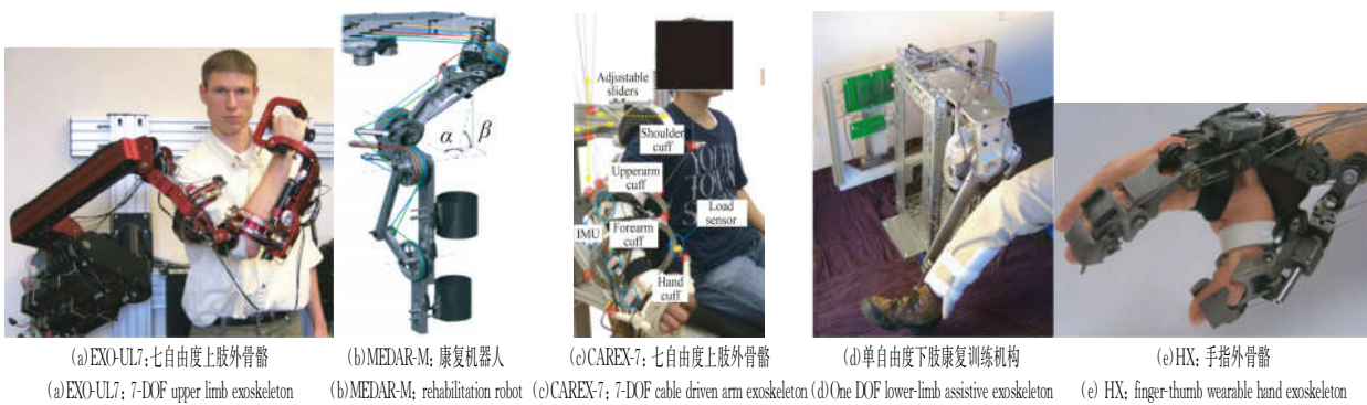
图4 柔索传动技术在康复机器人中的应用
