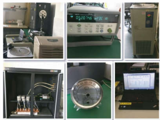
图 7 寿命试验系统实物展示
