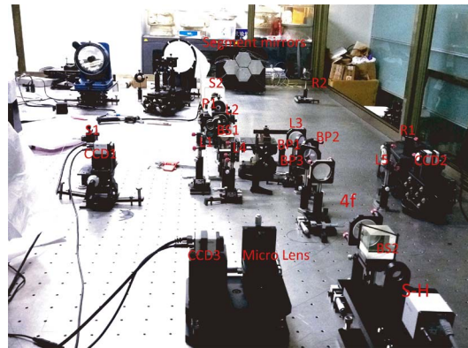
图 6 拼接镜实验系统照片
