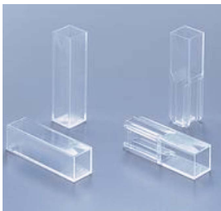
图 6 玻璃样品池实物图
