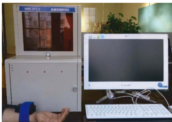
图 8 微创血糖连续检测样机
