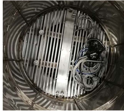
图 6 实验低温平台内部开放光路结构
