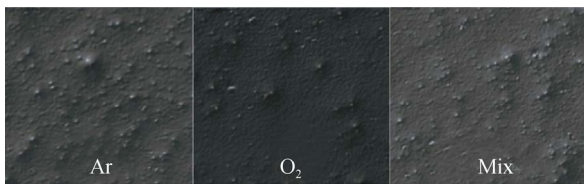
图4 不同气体等离子体处理后的表面形貌
