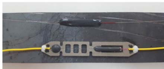
图 2 裸封光纤光栅与封装完成的传感器
