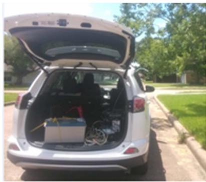
图 5 甲烷乙烷气体传感器车载实验照片
