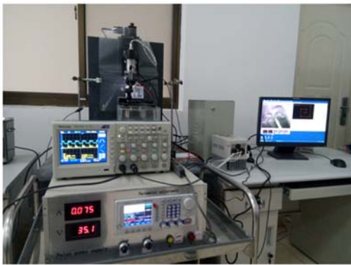
图2 使用旋转螺旋电极的电解放电加工试验系统照片 Fig.2 Photo of electrochemical discharge machining system with rotating spiral electrode
