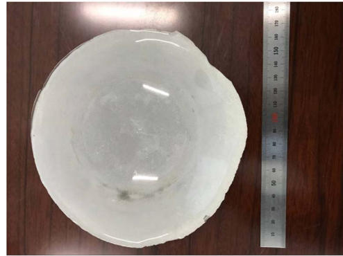
(a) 成型温度 950 °C 试验成型玻璃
