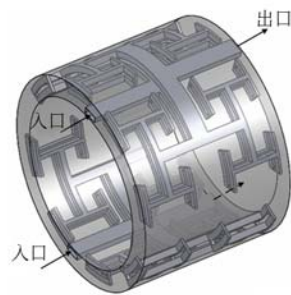
图 13 基于分形流道的主轴冷却温控结构示意图 [54] Fig. 13 Model of fractal tree-like channels net heat sink in cooling sleeve
