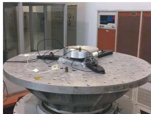
图 6 铝合金模拟镜振动测试现场
