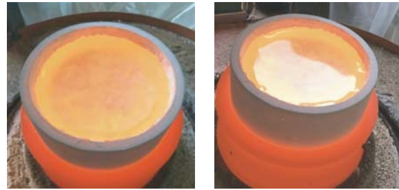
(c)成型及排气泡过程 (c) Forming and exhaust bubble process (d)成型结束 (d) Forming end
