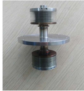
图 6 波纹管样机实物图 Fig. 6 Physical map of bellow
