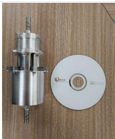
图 11 液体阻尼器实物图 Fig. 11 Physical map of damper
