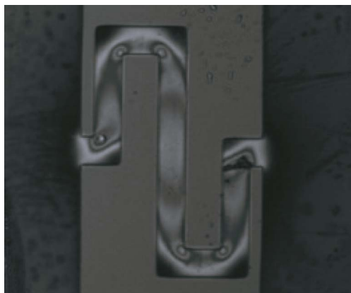
图 8 Pt 材料样品临界电流作用后桥区熔断情况
