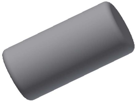
图 1 圆弧修正型凸度滚子的三维示意图 Fig. 1 Schematic of 3-D of circular arc modified convexity roller
