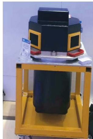
图12 大视场三线阵航空测绘相机实物照片
