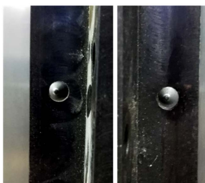
图 10 视觉引导的销钉对准情况
