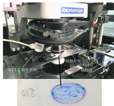
图1 结核杆菌涂片显微视觉检测系统
