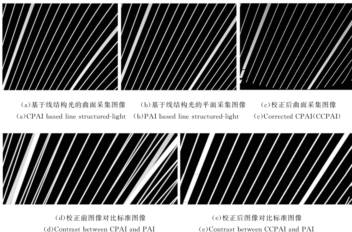
图 6 线结构光图像几何校正
