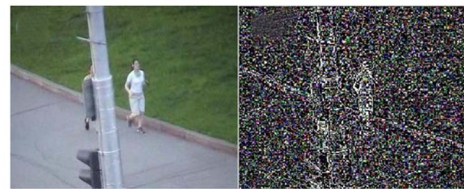
(a) 输入图像 (b) 图像签名重构图 (a) Input image (b) Reconstruction image of image signature
