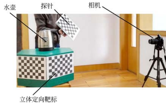
图 9 水壶的视觉测量现场
